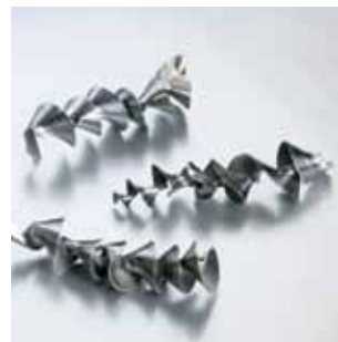
Пакетирование стружки CoroDrill Delta-C
