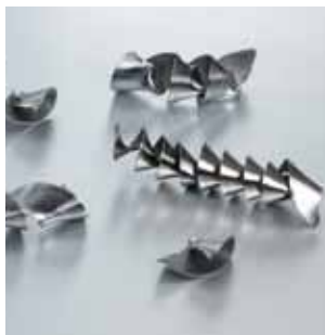
Приемлемая форма стружки CoroDrill Delta-C
